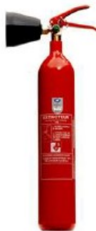
Extincteur CO2 B (et C) A pression permanente Feu de liquide – Gaz Adapté aux risques électriques
